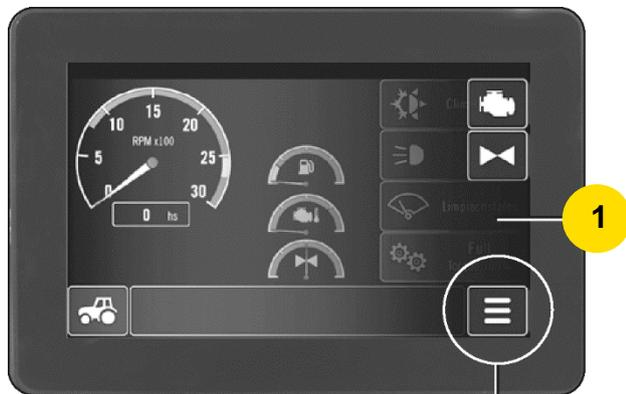
Сенсорная кнопка доступа к экрану дополнительных параметров
