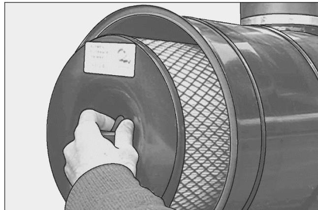
**Необходимо использовать фильтр грубой очистки воздуха**, чтобы избежать преждевременного загрязнения фильтрующего элемента тонкой очистки. Фильтр грубой очистки задерживает до 90 % загрязняющих частиц, продлевая срок службы фильтра тонкой очистки и двигателя. Фильтры грубой очистки являются самоочищающимися и не требуют обслуживания.
